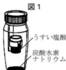
② 密閉したまま容器を傾けて、うすい塩酸をすべて炭酸水素ナトリウムと混ぜ合わせ、十分に反応させ、しばらくしてから再び容器全体の質量をはかった。
